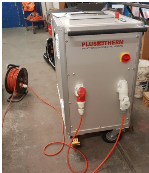
Abbildung 1: IP56 geschützter Tisch-Wagen mit integrierter Kühlung IP56 protected solution with integrated cooling
