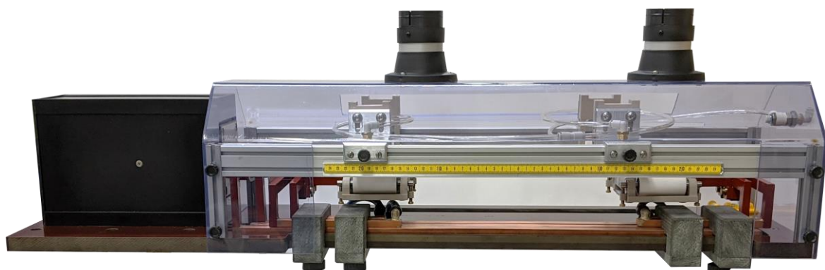
Figure 3: Induktor mit Führung von Folien oder ähnlichen Materialien Inductor with guiding of foils or similar materials
