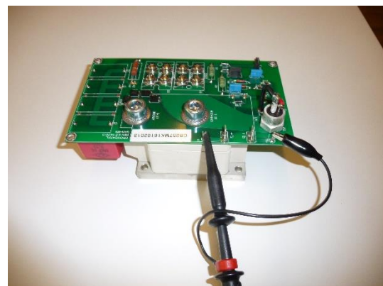
Abbildung 48: TNX60-200, mit interner H-Brücke. Auf dieser Platine befinden sich die Prüfstifte, an die Sie die Sonde anschließen können.
