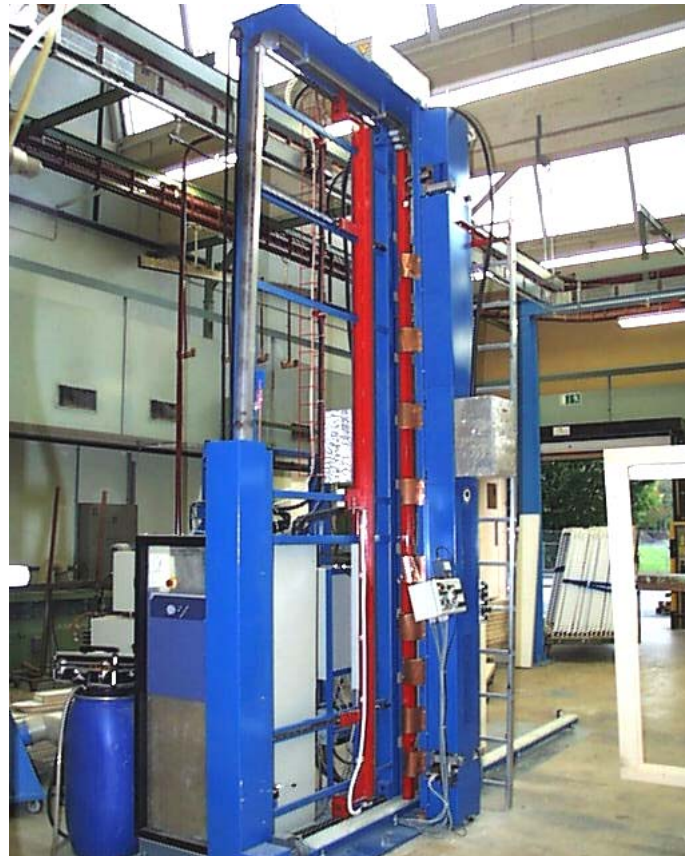
Bild 11 Fensterkantenverleimung ( mit freundlicher Genehmigung der Eggo Kiefer AG, Schweiz)
