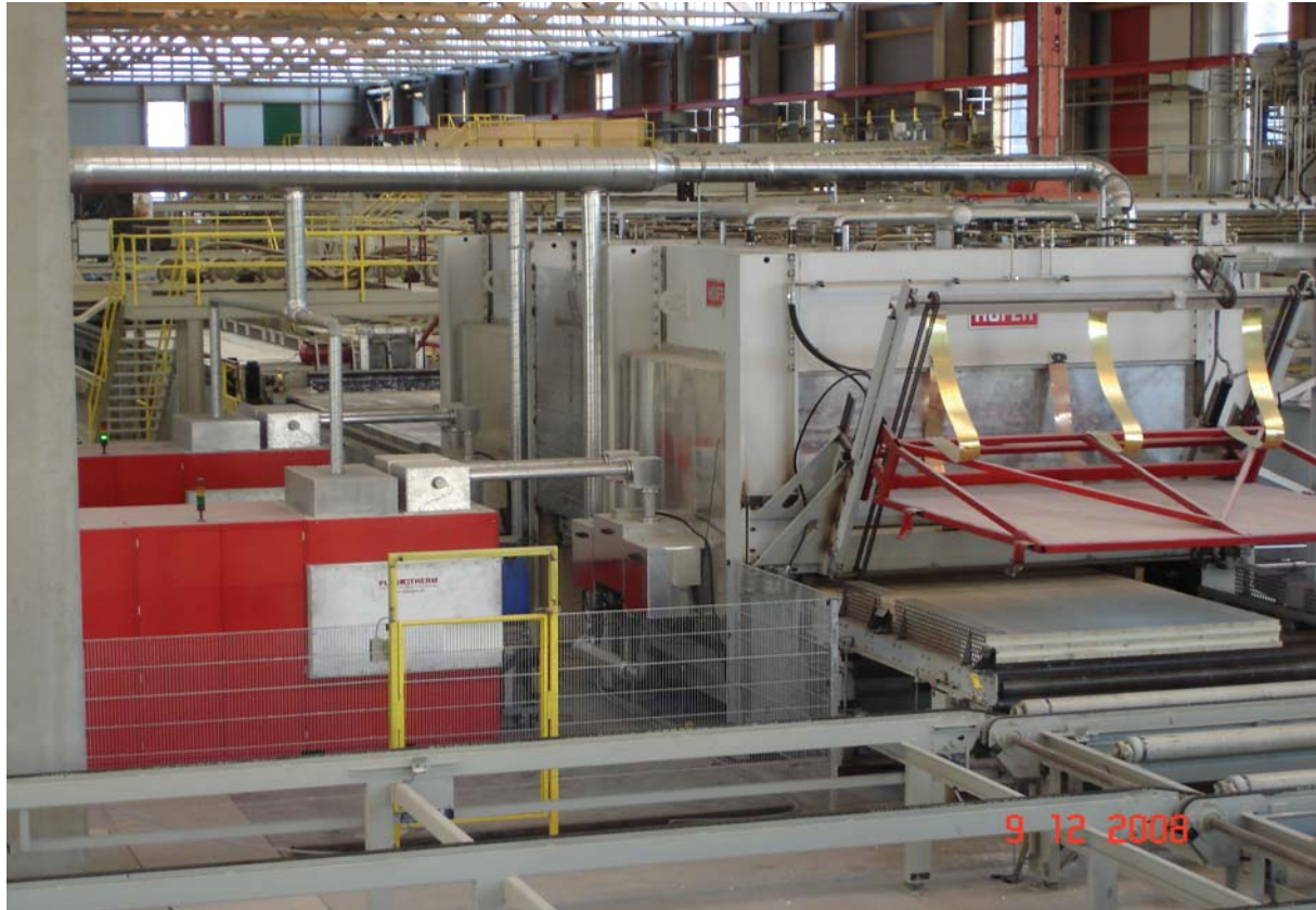
Bild 9. Die Verleimung von Brettsperholzplatten mit zwei Pressen gleichzeitig (mit freundlicher Genehmigung der Firma Mayr-Melnhof Systemholz Gaishorn GmbH )
