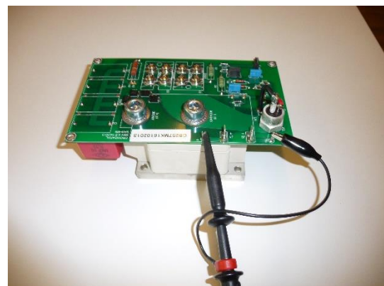
Abbildung 48: TNX60-200, mit interner H-Brücke. Auf dieser Platine befinden sich die Prüfstiften, an die Sie die Sonde anschließen können.
